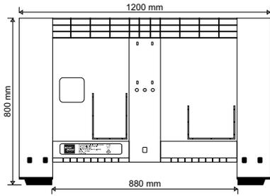
Die EUROPLAST Box CTH 2 aus hochwertigem HDPE wird im Spritzgussverfahren hergestellt. Eine extrem belastbare Box für die Industrie, in der Lebensmittelproduktion, für Schüttgut und Kleinteile. Optimal für Transport- und Lagerhaltung. Die EUROPLAST CTH 2 Box ist lebensmittelecht, hat glatte Innenwände die sich leicht reinigen lassen. Die EUROPLAST CTH 2 ist mit 4 Füßen oder 2 Traversen lieferbar.
