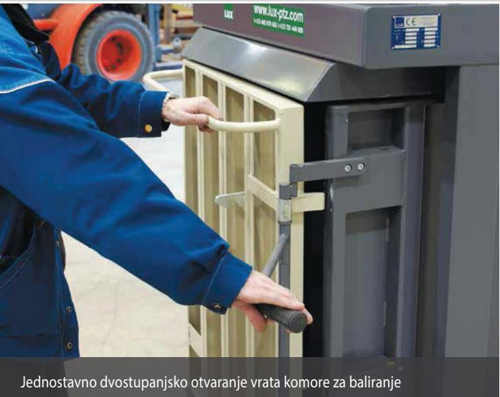
Jednostavno dvostupanjsko otvaranje vrata komore za baliranje
