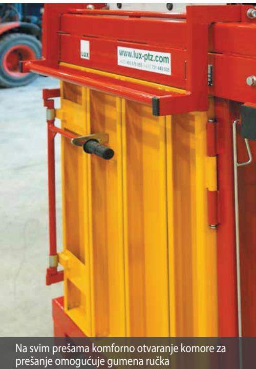
Na svim prešama komorno otvaranje komore za prešanje omogućuje gumena ručka
