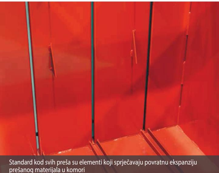
Standard kod svih preša su elementi koji sprječavaju povratnu ekspanziju prešanog materijala u komori
