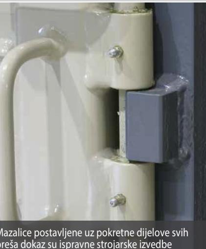
Mazalice postavljene uz pokretnе dijelove svih preša dokaz su ispravne strojarske izvedbe
