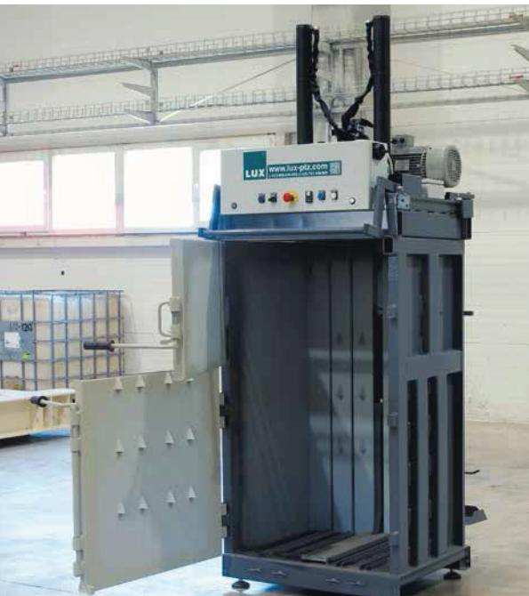
Kompaktna modularna konstrukcija s podijeljenim vratima. Vrlo visok broj elemenata koji sprječavaju povratnu ekspanziju prešanog materijala u komori
