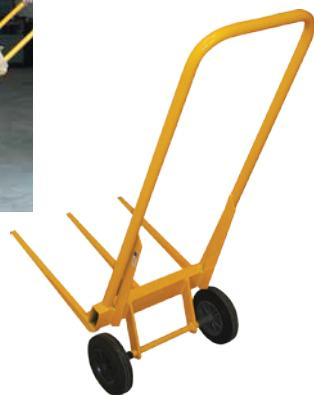
Ručna kolica za jednostavnu manipulaciju s prešanim balama
