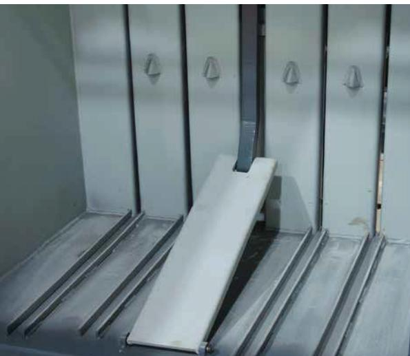
Preša ima mehanizam za kipanje teške prešane bale iz komore
