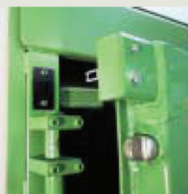
Kodirani sigurnosni prekidač prema EN 60-947-5-1
