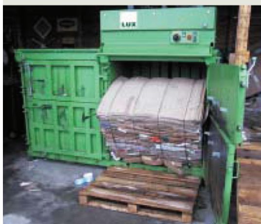
Dvokomorna preša L30-2 – prikaz izbacivanja bale na paletu – karton, 390 kg
