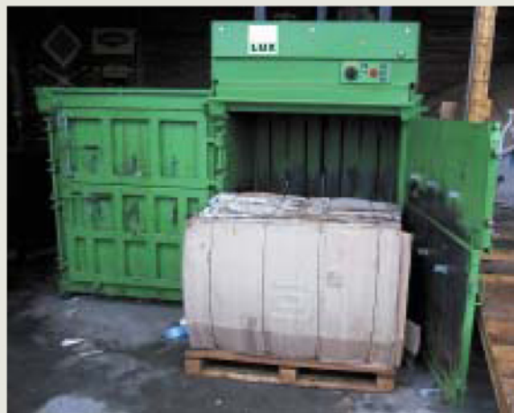
Dvokomorna preša L30-2 – prikaz izbacivanja bale na paletu – karton, 390 kg
