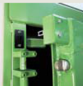
Kodirani sigurnosni prekidač prema EN 60-947-5-1
