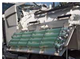
Držači crijeva - hidraulično pokretani, upravljanje daljinskim telekomandama
